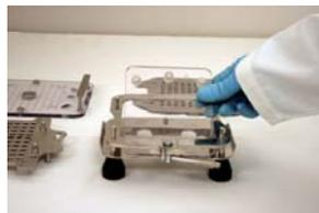
5. Extraiga la placa transparente del espaciador y reemplácela con el nuevo tamaño de la placa espaciadora.
