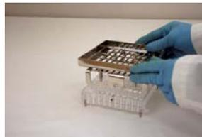
2. Coloque el nuevo tamaño de la bandeja del orientador y apriete los 2 tornillos de mariposa.
