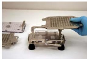
6. Coloque el nuevo tamaño de la placa del cuerpo "a", después "b", después "c" en las espigas posicionadoras.
