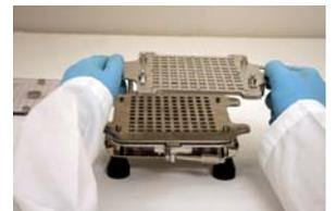
7. Coloque el nuevo tamaño de la bandeja de cápsulas. Usted está listo para llenar un nuevo tamaño de cápsula.
