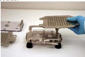
4. Ajuste la palanca de leva en la posición 3 del reloj. Quite las 3 placas del cuerpo.
